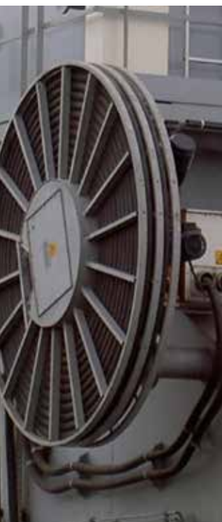
Bobina monoespacial dupla , com dois cabos idênticos e seções transversais grandes.
